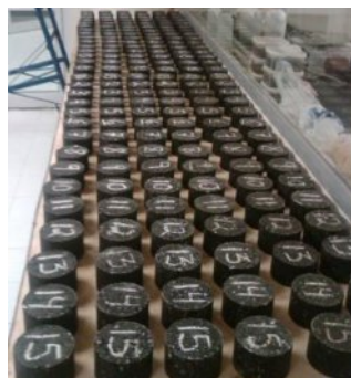
Figura 1. Probetas empleadas en el estudio empleando RAP. (Díaz Derbez, et al, 2010)
